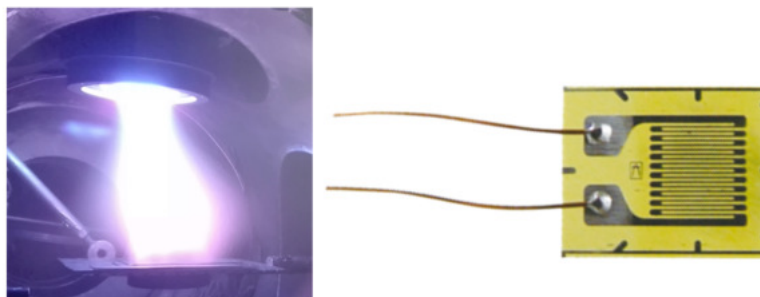
Figuur 1 : Een magnetron ontlading (links) Voorbeeld van een dunne laag reksensor (rechts)
